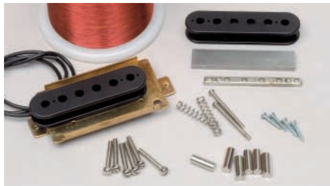
En humbucker består av dessa 26 delar plus ca 1,5 kilometer tråd.
